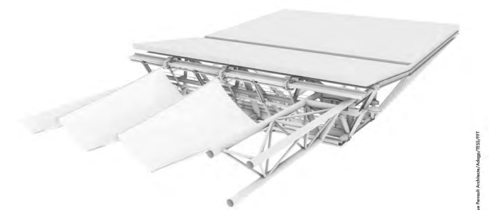
la toile tendue, le buton mobile et la poutre mobile
